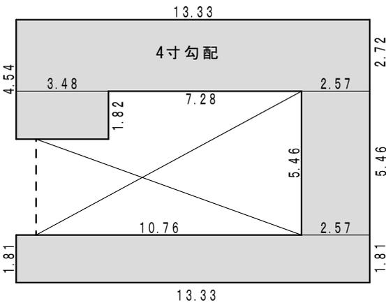
2階屋根平面面積 78.60㎡ 4寸勾配 延び率 1.077
